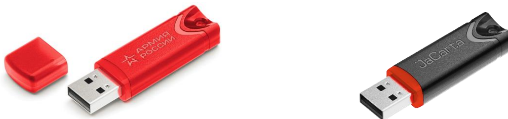
Рисунок 1 – Внешний вид USB-носителя «JaCarta SF/ГОСТ», тип 1, исполнение 6 АЛДЕ.467669.004-06, варианты корпуса 1 и 2
